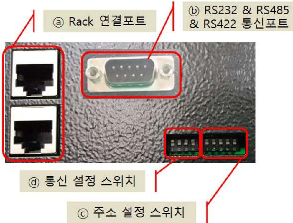
그림 1. Tray 및 배터리 외부 포트
